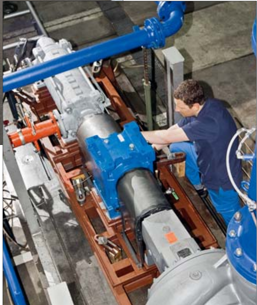
Ein Pumpenaggregat auf einem Prüfstand im KSB-Werk Frankenthal.
