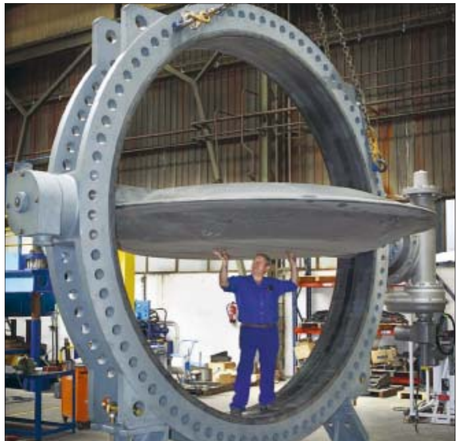
Absperrklappen mit einem Innendurchmesser von 3,5 Metern, wie sie auch in einer der weltweit größten Meerwasserkühlanlagen am Persischen Golf zum Einsatz kommen werden.
