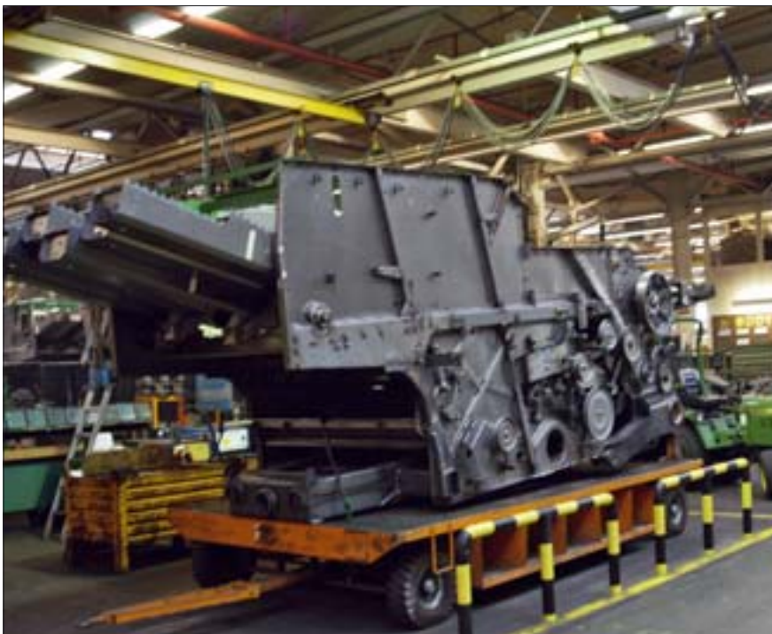
Das Herzstück eines jeden Mähdreschers: Dieser Kasten leistet die komplette Erntearbeit.
