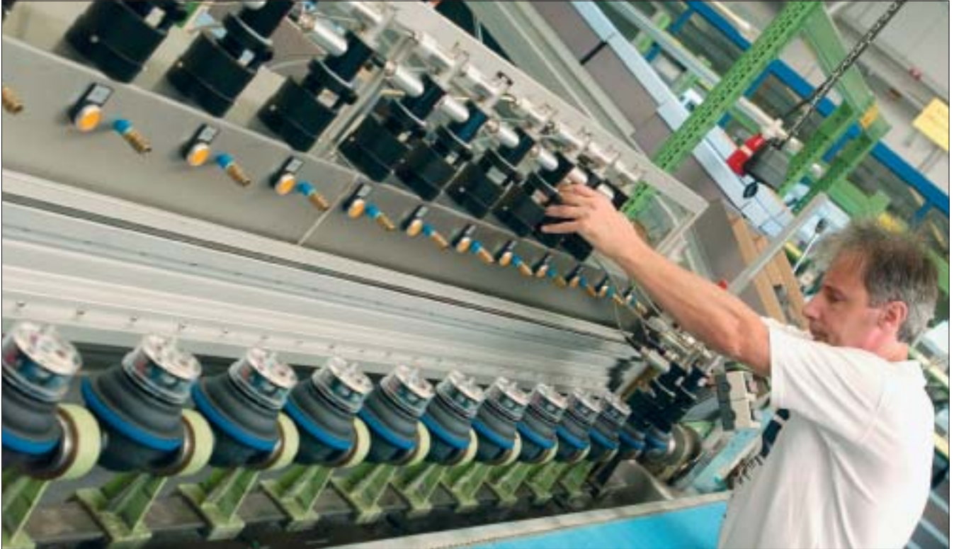
Auf den Bruchteil eines Millimeters genau montiert und im Detail überprüft sind die vielen der kleinen und kleinsten Bauteile, die zu einem Wasserzähler aus dem Ludwigshafener Standort der nordamerikanischen Sensus Metering Systems gehören.
