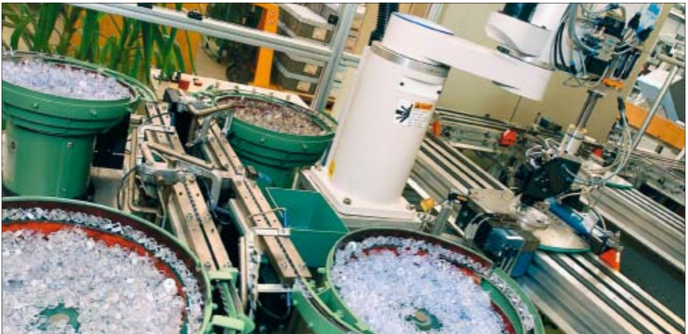
Blick auf die Zahnradzuführung einer vollautomatischen Wasserzähler-Fertigungslinie am Ludwigshafener Sensus Metering-Standort.
