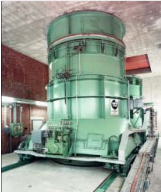
Ein fahrbarer Grubenventilator aus der TLT-Produktion.
