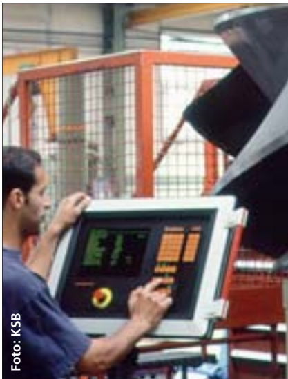
KSB-Mitarbeiter beim Bearbeiten eines Laufrades für Kühlwasserpumpen.
