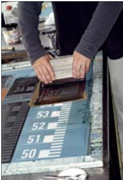
Viel Handarbeit gibt es noch heute in der Emailschilderproduktion, so wie hier, beim Färben der Träger.
