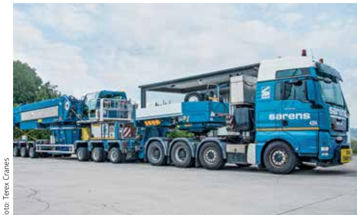
Gut verstaut: Der neue Sockelkran Demag PC 3800-1 beim Transport auf einem Lkw-Tieflader.
