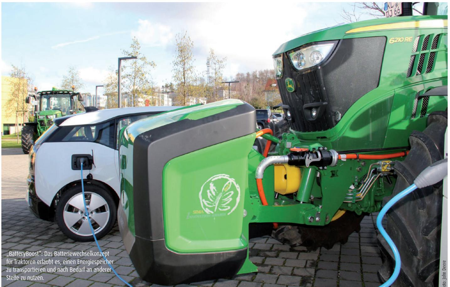
„BatteryBoost“: Das Batteriewechselkonzept für Traktoren erlaubt es, einen Energiespeicher zu transportieren und nach Bedarf an anderer Stelle zu nutzen.
