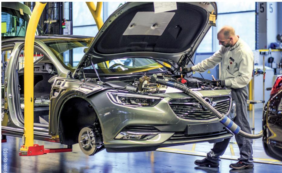
Ende März begann die Serienproduktion des Insignia der zweiten Generation. In der Endmontage werden die Fahrzeuge mit allen Flüssigkeiten befüllt.
