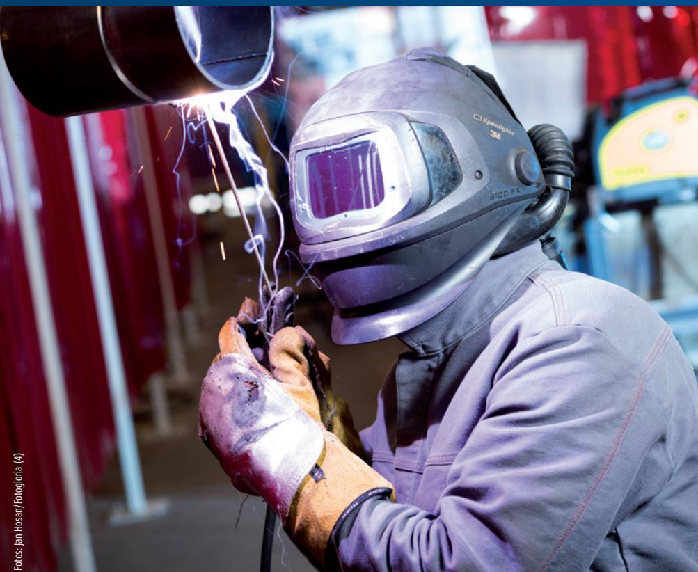
Terex-Mitarbeiter Elias Sutter in seinem Metier: dem Lichtbogenhand- oder Elektrodenschweißen.
