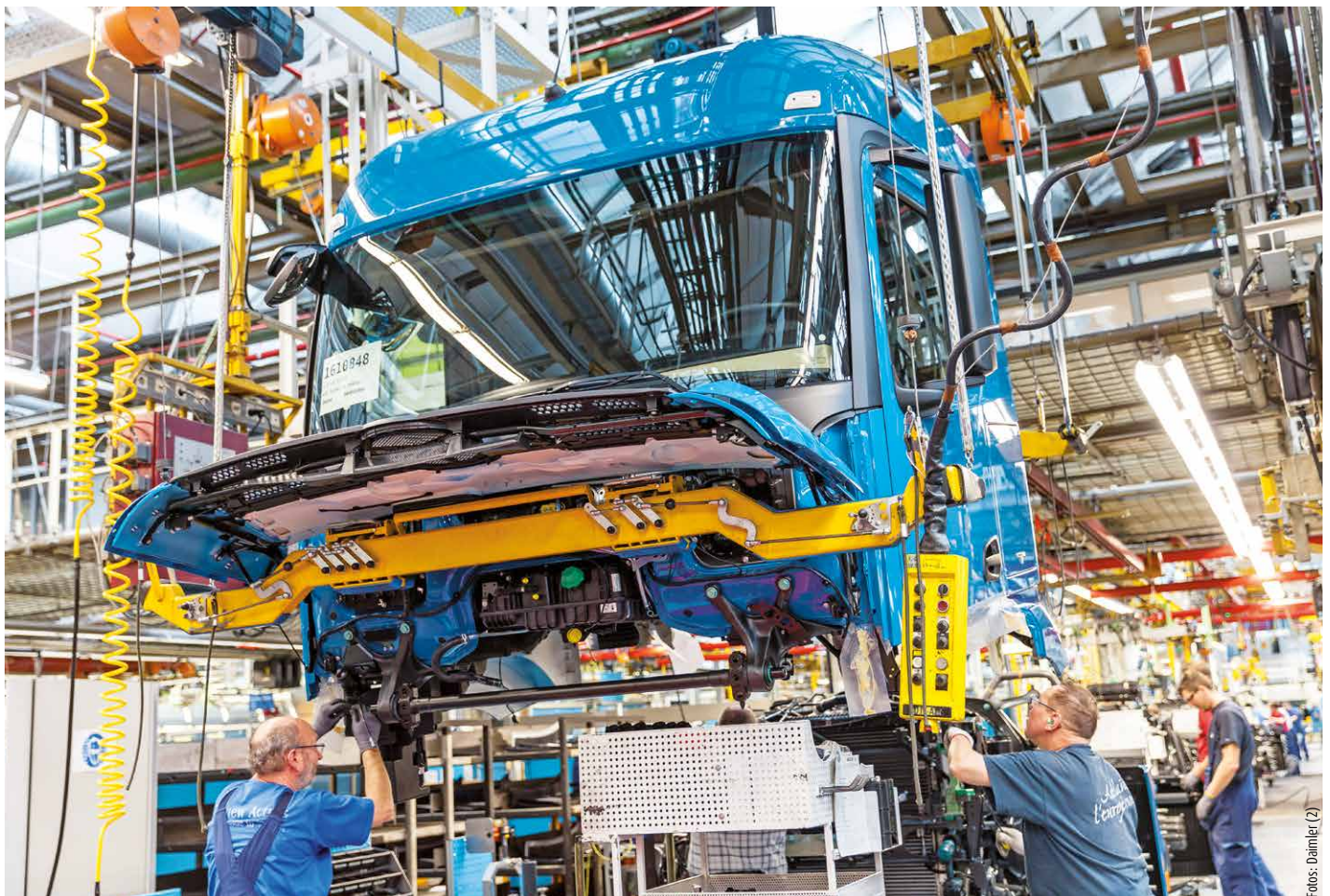
Mitarbeiter setzen das Fahrerhaus auf den Rahmen. Dieser Produktionsschritt wird Hochzeit genannt. Von diesen gab es 2015 im Werk Wörth viele – die Produktion lief am Anschlag.
