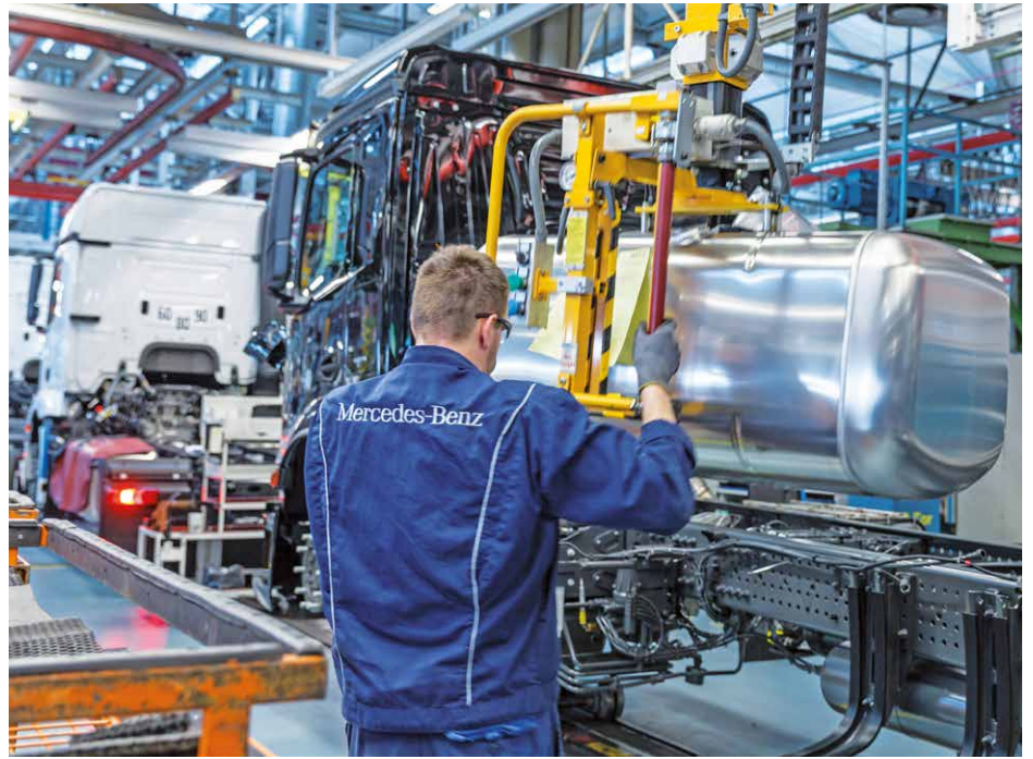
Ein Mitarbeiter in der Aufbaumontage im Mercedes-Benz Werk Wörth platziert einen Tank an einem Lkw.
