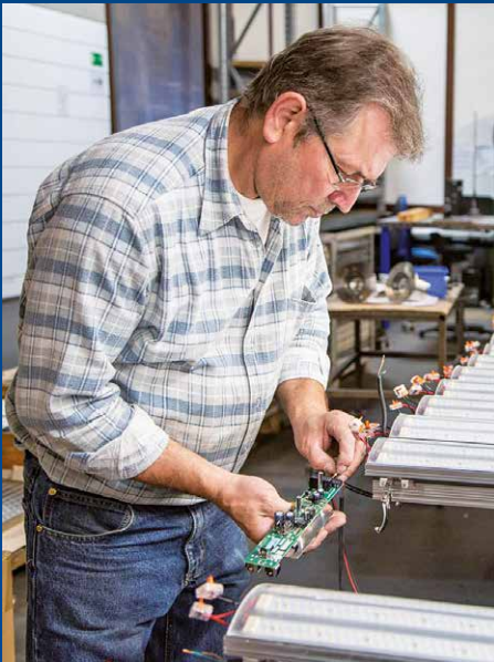
Ein Mitarbeiter von ERGO-FIT montiert LED-Leuchten.
