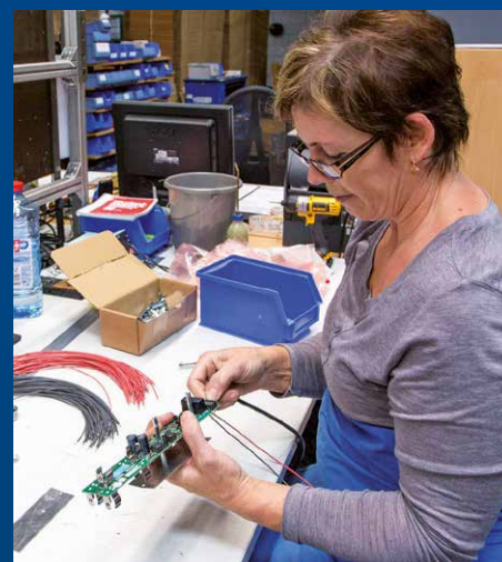
Fertigung der Steuergeräte für LED-Lampen.
